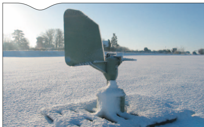
Figure 2. Piège à spore volumétrique (Burkard) positionné dans une parcelle de blé expérimentale de l'INRA de Grignon (78) pendant la phase précoce hivernale d'une épidémie de septoriose.
