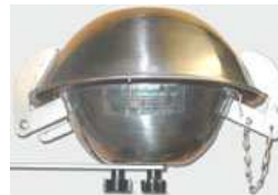
Echantillonneur passif d'air ambient 24 bureaux, 28 jours
