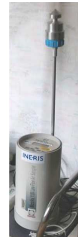
Préleveur d'air actif MicroVol 12 bureaux, 48h
