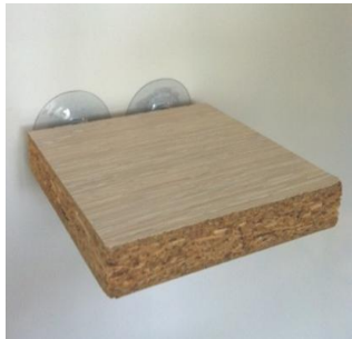
Plaque développée par l'INERIS pour échantillonner les poussières 24 bureaux, 28 jours
