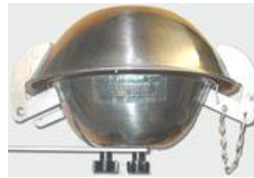
Echantillonneur passif d'air ambient 24 bureaux, 28 jours
