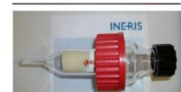
Cartouche PUF/XAD2/PUF avec adaptation INERIS pour connexion au Microvol
